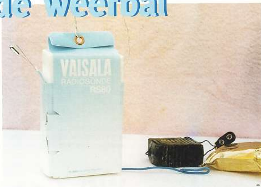
De VAISALA radiosonde RS80 in zijn verpakking met de batterij er naast. De batterij is tijdens de vlucht in de goudkleurige plastic zak verpakt.
